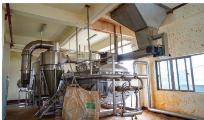
越南百和工業黎明春廠(台商) 污泥乾燥機 - 10噸乾重污泥/天 Máy sấy bùn, 10 tấn bùn trọng lượng khô/ ngày Nhà máy Lê Minh Xuân - CÔNG TY TNHH VIỆT NAM PAIHO (ĐÀI LOAN)
