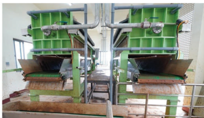
越南百和工業黎明春廠(台商) 污泥乾燥機 - 10噸乾重污泥/天 Máy sấy bùn, 10 tấn bùn trọng lượng khô/ ngày Nhà máy Lê Minh Xuân - CÔNG TY TNHH VIỆT NAM PAIHO (ĐÀI LOAN)
